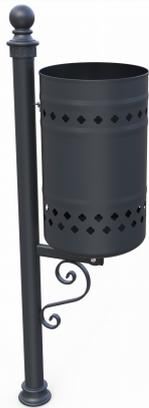
**Cestino portarifiuti** di forma cilindrica, in lamiera zincata spessore 10/10. Fondo sagomato in lamiera in acciaio zincata spessore 15/10 con fori di scarico delle acque meteoriche. Sistema di svuotamento mediante estrazione del sacco o con sgancio della vite e ribaltamento frontale.
