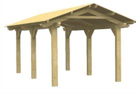
**GAZEBO IN LEGNO** con struttura portante in legno. Le parti in legno sono realizzate in pino -. montanti in legno bilama a sezione contrapposta, copertura in doghe di legno a 2 falde, manto di copertura in tegola canadese colore grigio-verde. comprese le strutture in acciaio e/o legno necessarie per l'irrigidimento e controventatura.
